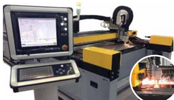
«РИТМ-НП» — порталная, с линейным электромагнитным приводом, лазерная
