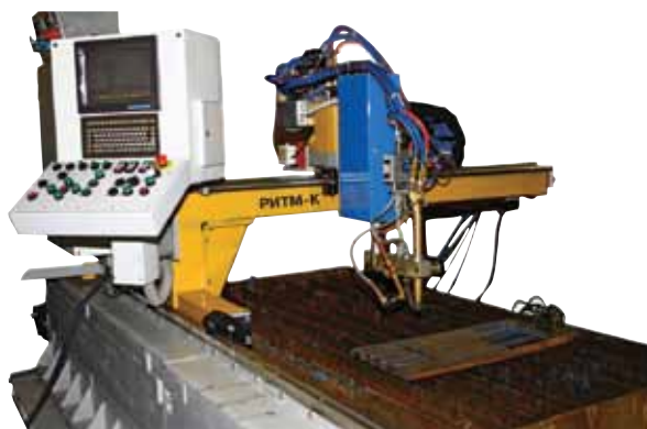
«РИТМ-М» — порталная с двухсторонним приводом, газоплазменная
