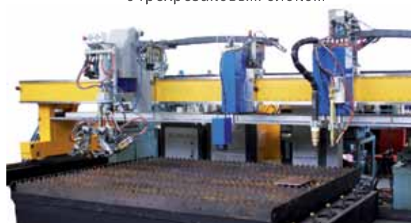
«РИТМ-М-2,5 3P» — широкопортальная, комбинированная газоплазменная с трехрезаковым блоком
