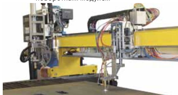
«РИТМ-3D» — широкопортальная, комбинированная газоплазменная с плазменным поворотным модулем
