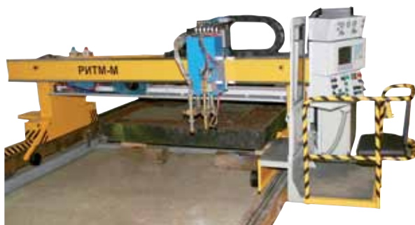
«РИТМ-М» — порталная с двухсторонним приводом, газоплазменная
